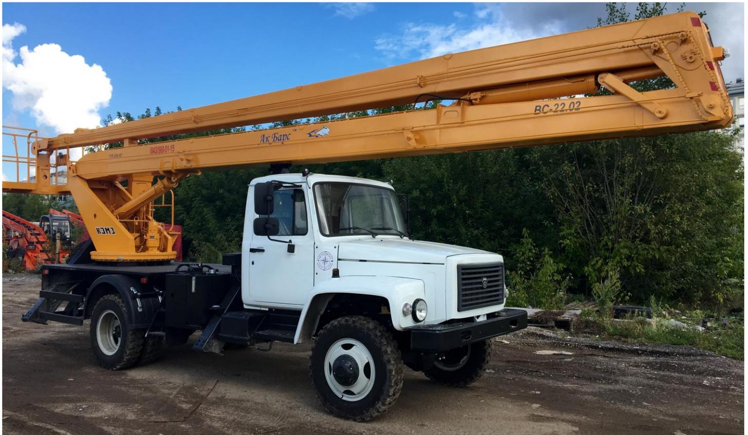
Автогидроподъемник BC-22.02 двухколенный предназначен для проведения строительно-монтажных и эксплуатационных работ в различных сферах производства, требующих подъема людей с материалами и инструментами на высоту до 22 м.
